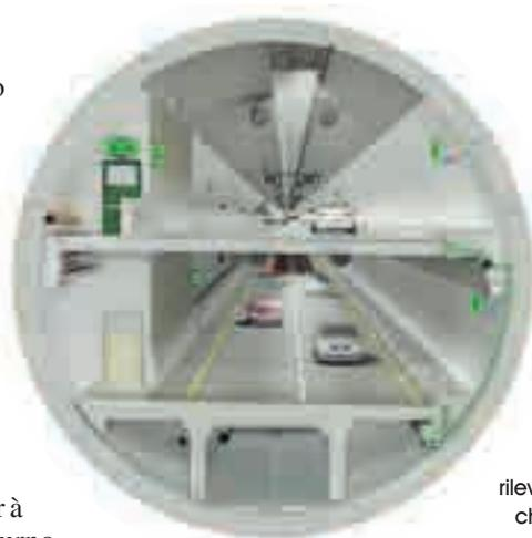
Il tunnel sottomarino Eurasia che collegherà due continenti con 15 km di autostrada di cui 3,4 costruiti a una profondità di 25 metri. La struttura a sandwich con tre piani sovrapposti (l'ultimo destinato ai servizi) è la novità tecnica rilevante di quest'opera che dovrebbe essere terminata nel 2018
